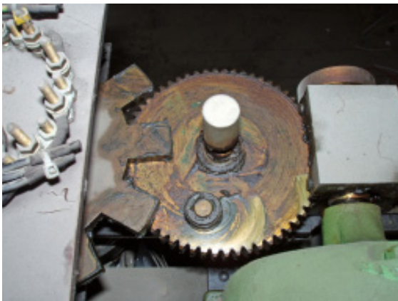
Bild des Drehschalters mit Nockentrieb
